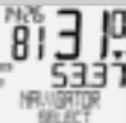
Listujte tlačítky ▲▼ k NAVIGATOR/SELECT. Potvrďte pomocí M.
