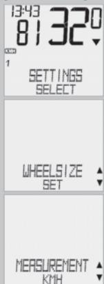
Listujte tlačítky ▲▼ k SETTINGS/SELECT. Potvrďte pomocí M. Nyní se nacházíte v režimu nastavení (přidržením tlačítka C přidržením tlačítka.
