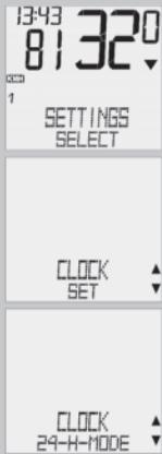
Listujte tlačidlami ▲▼ k SETTINGS/SELECT. Potvrďte pomocou M. Nachádzate sa v režime nastavení (stlačením C po dobu 3 sekúnd prejdete späť do režimu funkcií).
