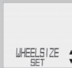
Listujte tlačidlami ▲▼ k WHEELSIZE/SET. Potvrdte pomocou M.
