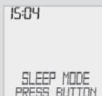
Na displeji sa zobrazí SLEEP MODE/PRESS BUTTON. Pred ďalšou jazdou musíte stlačiť tlačidlo, aby sa rádiový prijímač opäť zapoji.
