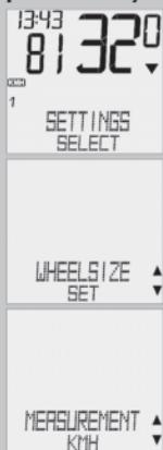
Listujte tlačidlami ▲▼ k SETTINGS/SELECT. Potvrďte pomocou M. Teraz sa nachádzate v režime nastavení (pridržte tlačidlo C).
