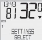
Listujte tlačidlami ▲▼ k SETTINGS/SELECT. Potvrďte pomocou M. Nachádzate sa v režime nastavenia (stlačením C po dobu 3 sekúnd prejdete späť do režimu funkcií).
