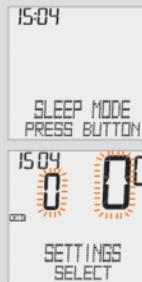
Na displeji se zobrazí SLEEP MODE/PRESS BUTTON. Před další jízdou musíte stisknout tlačítko, aby se rádiový přijímač opět zapnul.
