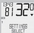
Listujte tlačidlami k SETTINGS/SELECT. Potvrdte pomocou . Nachádzate sa v režime nastavenia (stlačením po dobu 3 sekúnd prejdete späť do režimu funkcií).
