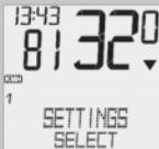
Listujte tlačítky ▲▼ k SETTINGS/SELECT. Potvrďte pomocí M. Nacházíte se v režimu nastavení (stisknutím C po dobu 3 sekund přejdete zpět do režimu funkcí).
