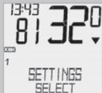
Listujte tlačítky ▲▼ k SETTINGS/SELECT. Potvrďte pomocí M. Nacházíte se v režimu nastavení (stisknutím C po dobu 3 sekund přejdete zpět do režimu funkci).
