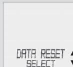
Listujte tlačidlami ▲▼ k DATA RESET/SELECT. Potvrďte pomocou M.
