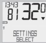
Listujete tlačítky ▲▼ k SETTINGS/SELECT. Potvrďte pomocí M. Nacházíte se v režimu nastavení (stisknutím C po dobu 3 sekund přejdete zpět do režimu funkcí).
