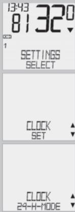
Listujte tlačítky ▲▼ k SETTINGS/SELECT. Potvrďte pomocí M. Nacházíte se v režimu nastavení (stisknutím C po dobu 3 sekund přejdete zpět do režimu funkci).
