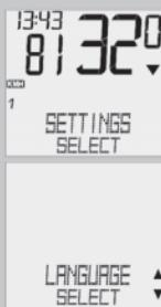
Přejděte pomocí posouvání tlačítky ▲▼ k SETTINGS/SELECT. Potvrďte pomocí **M**. Nacházejte se v režimu nastavení (stisknutím **C** po dobu 3 sekund přejdete zpět do režimu funkcí).
