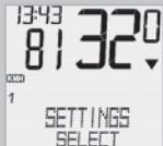
Listujte tlačidlami ▲▼ k SETTINGS/SELECT. Potvrďte pomocou M. Nachádzate sa v režime nastavení (stlačením C po dobu 3 sekúnd prejdete späť do režimu funkcií).
