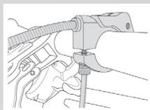
Namontujte ovládání z řídítek na řídítka a upevněte je pomocí 3mm imbus klíče. Doporučený utahovací moment: 1,6Nm
