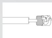
**Poznámka:** Při vnějším vedení bowdenu se zámek (čep) patrony upevní do těla podsedlové objímky. Při vnitřním vedení bowdenu se zámek (čep) patrony upevní do spodního víčka.
